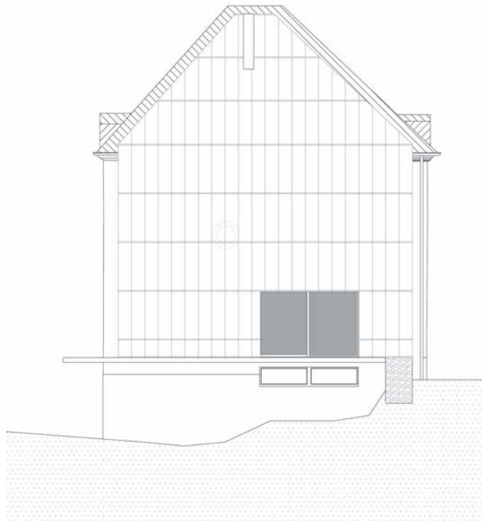
Ansicht Südwest mit Luftkollektor 1:200
